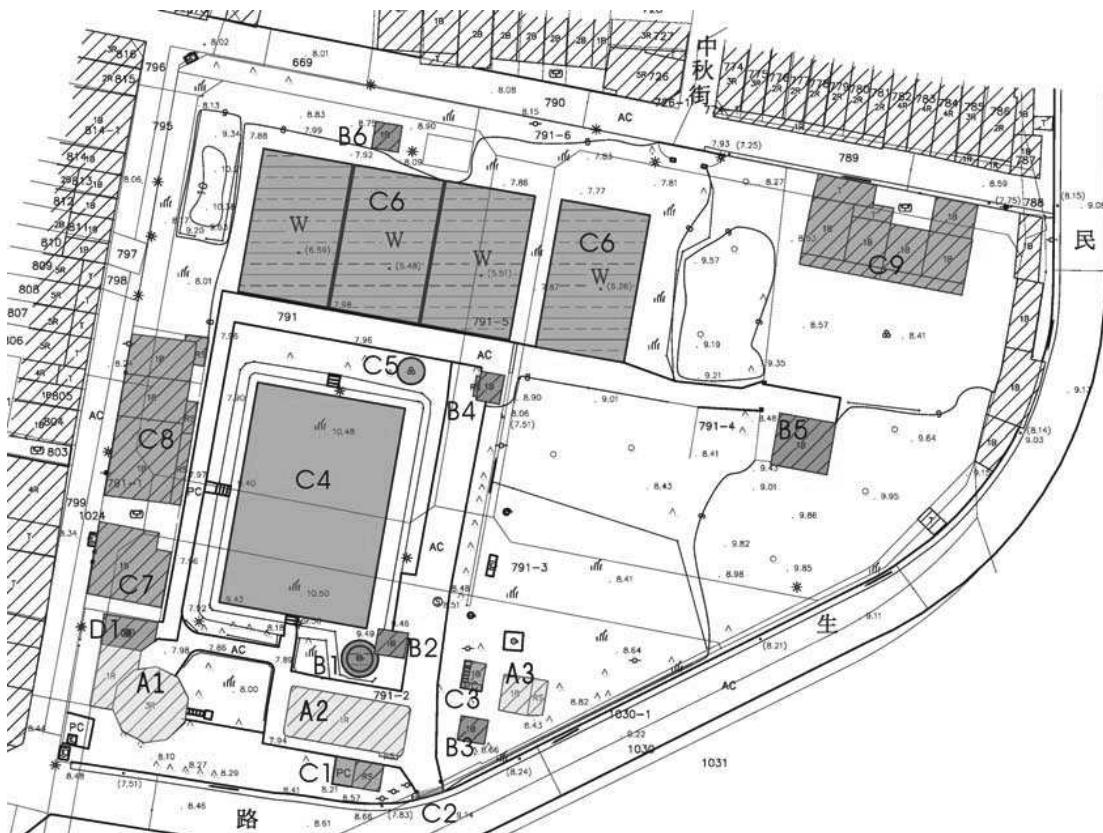
A1：高架水塔（1930）、A2：抽水機房（唧筒室 1930）、A3：倉庫（深井抽水機房，1956）、B1：氣曝塔（1956）、B2：消毒室（1956）、B3：加藥機房（約 1956）、B4：排水井(含建物 1933)、B5：倉庫（約 1956）、B6：倉庫（1956）、C1：第一、第二唧筒井（1930）、C2：大門（2006）、C3：接線箱與藥劑（2006）、C4：清潔池（約 1956）、C5：沉澱井（分水井、連絡井 1930）、C6：濾過池（慢濾池 1930）、C7：廠長宿舍（1930）、C8 員工宿舍（約 1930）、C9：員工宿舍（約 1956）、D1：辦公室（約 1930）。
